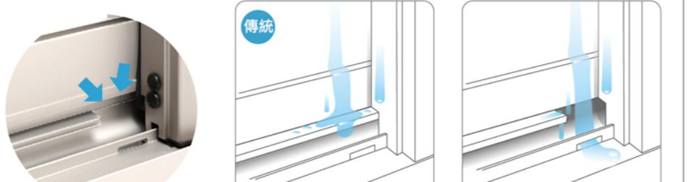
利用階梯斷水設計可讓窗上的雨水迅速由排水孔排除，避免雨水累積滲入室內。
